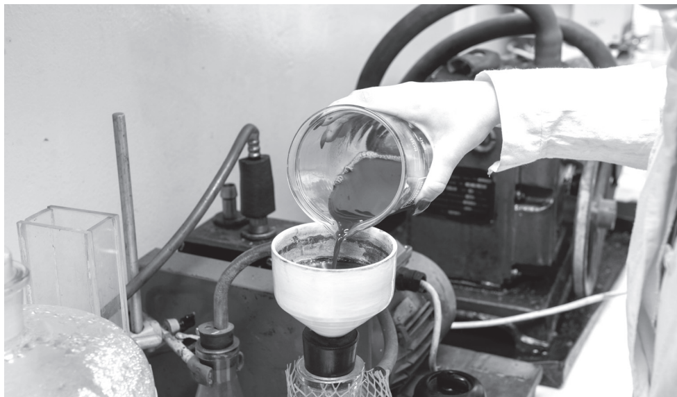
Гуминовые кислоты фильтруем, чтобы «освободить» от раствора, а осадок кислот остается на фильтре
