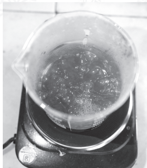
Раствор кека с добавленным к нему гидроксидом натрия кипятим в течение часа и получаем раствор гуматов
